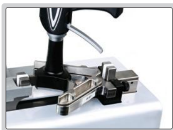
三点内径千分尺对零或校验
